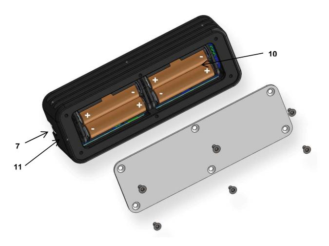
Il est nécessaire de déposer les vis de fixation du capot inférieur pour accéder au compartiment à piles.
